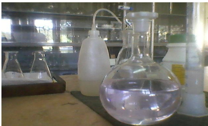
Figura 9: Balão volumétrico contendo solução rosa pálida de éter/álcool 1:1 e indicador fenoftaleína, neutralizada com hidróxido de sódio 0,1N.
