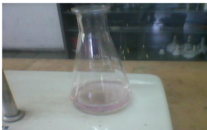
Figura 10: Erlenmeyer contendo uma amostra titulada com hidróxido de sódio a 0,1N.
