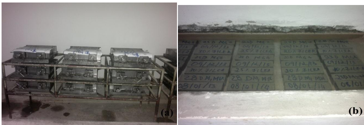
Figura 5: Molde com argamassa na câmara húmida (a) e Provetes em cura na água (b).
