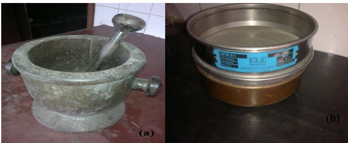
Figura 3: Triturador Manual (a) e Peneiro de 150 µm (b).
