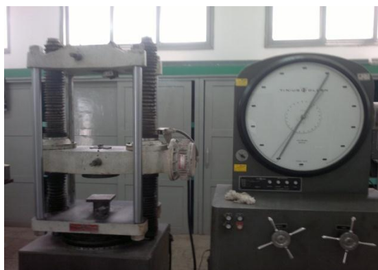
Figura 7: Prensa usada para o ensaio da resistência à compressão
