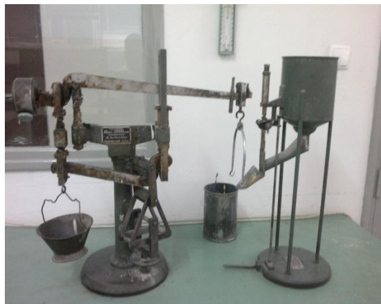
Figura 6: Prensa usada para o ensaio da resistência à flexão
