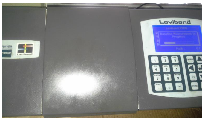
FIG. 20: Imagem do aparelho de Lovibond, usado na leitura da coloração do óleo de soja.
