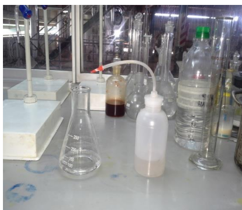
FIG. 14: Frasco de erlenmeyer contendo álcool etílico e gotas do indicador.
