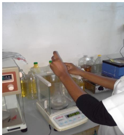
Fig. 16: Pesagem da amostra de óleo a ser analisado.
