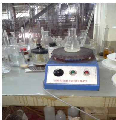
FIG. 17: Aquecimento do óleo após a pesagem.
