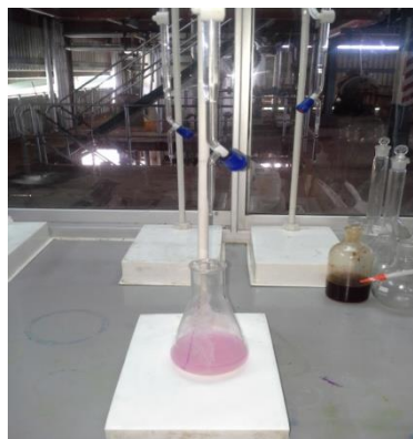
FIG. 18: Reaparecimento da cor violeta pálida após a titulação do óleo com NaOH
