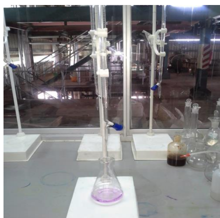
FIG.15: Aparecimento da cor violeta pálida após a titulação com NaOH.
