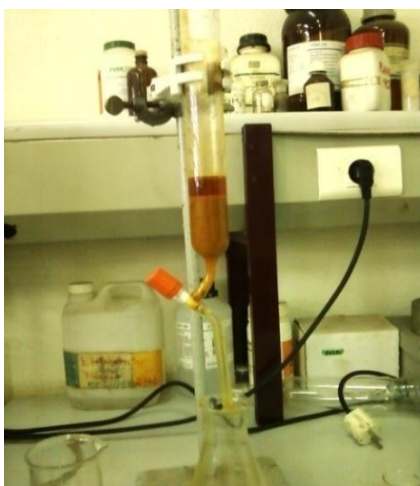
Fig. 3 - Ampola de decantação usada para extrair alcalóides totais
