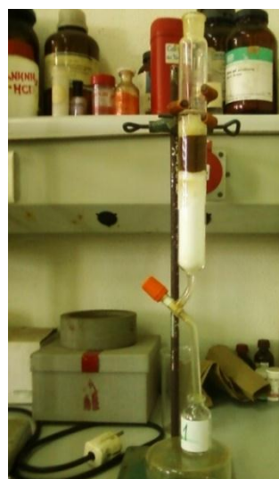
Fig. 4 – Ampola de decantação usada para fraccionamento do extracto clorofórmico de Z. capense
