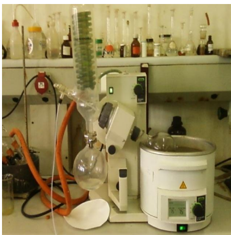
Fig. 1 - Rota vapor usado para concentrar o extracto metanólico
