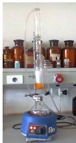
Fig. 2 – Extracção por Soxhlet
