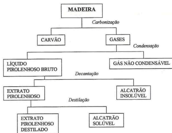
Figura 16. Fluxograma de obtenção do Alcatrão vegetal e Vinagre bruto. Fonte: (Alves, 2003)
