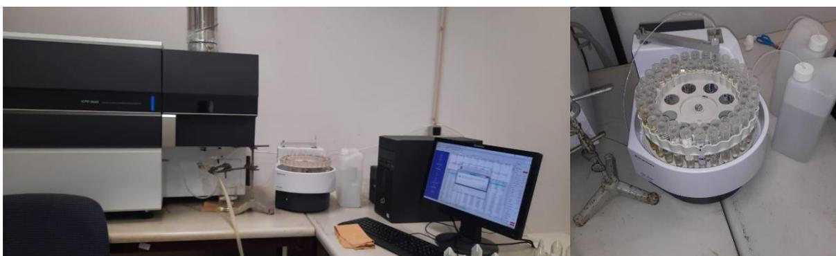
Figura 23. Imagem do Espectrómetro de emissão ICP-OES
