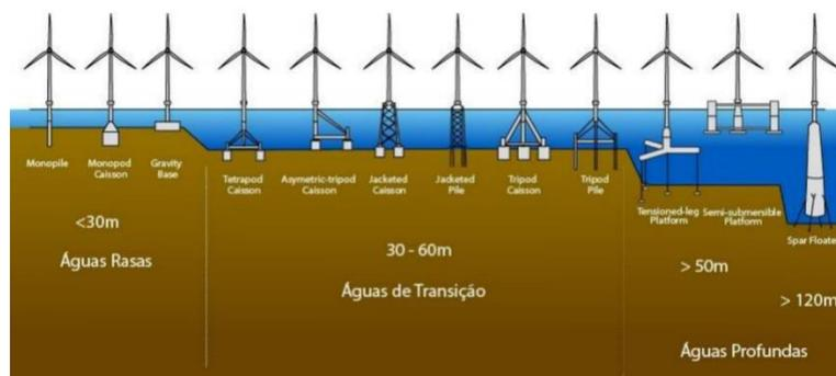
Figura 13. Tipos de fundação de turbinas eólicas *offshore* e sua profundidade adequada. (Fonte: Google.com)
