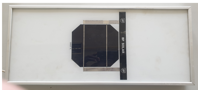
Figura 18: Piranómetro fotovoltaico. Fonte: autor.
