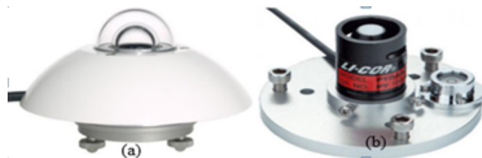
Figura 5: (a) Piranómetro termoeléctrico e (b) fotovoltaico (Costa, 2021).
