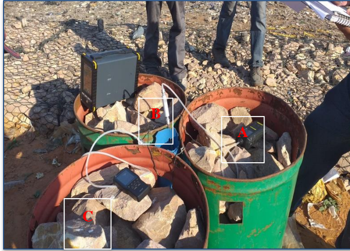
Figura 9: A-Equipamento utilizado para medição do gás CH 4 ; B- Equipamento para medição dos outros gases (CO, CO 2 , O 2 , NO 2 , SO 2 , H 2 S e H 2 ); C- Equipamento utilizado na medição da temperatura e humidade.
