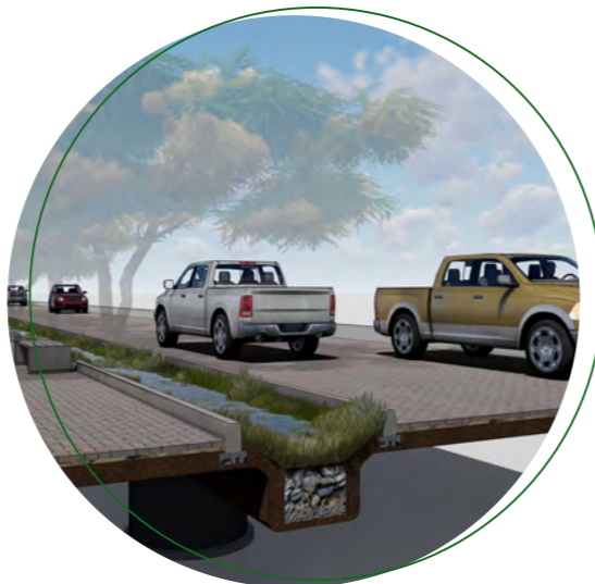
VALAS REVESTIDAS AO LONGO DAS VIAS
