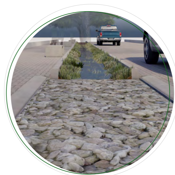
TRINCHEIRAS DE INFILTRAÇÃO AO LONGO DAS VIAS EM ESPAÇOS EM QUE É NECESSÁRIO A PASSAGEM DE VEÍCULOS E/OU PEÕES.
