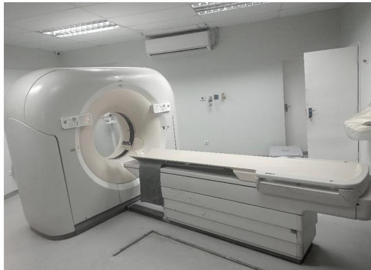
**Figura 3.1:** Equipamento de tomografia computadorizada. Fonte: Autor.
