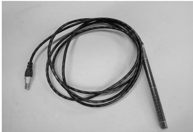
**Figura 3.2:** Câmara de ionização do tipo lápis. Fonte: Autor.
