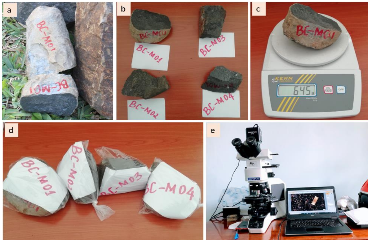
Figura 12. Procedimentos laboratoriais e equipamentos utilizados desde a amostragem (a), dimensionamento e etiquetagem das amostras (b), pesagem de amostras para o envio ao laboratório (c e d) e descrição petrográfica das laminas delgadas (e).
