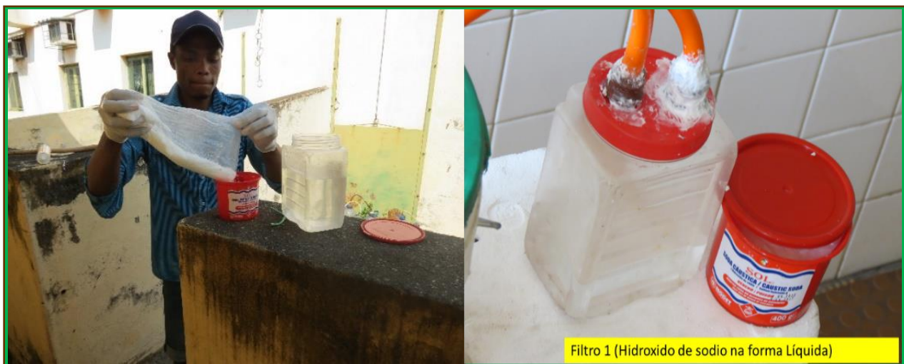
Figura xiv: Preparação da Solução de Hidróxido de sódio (Esquerda); Filtro 1 (Direita)
