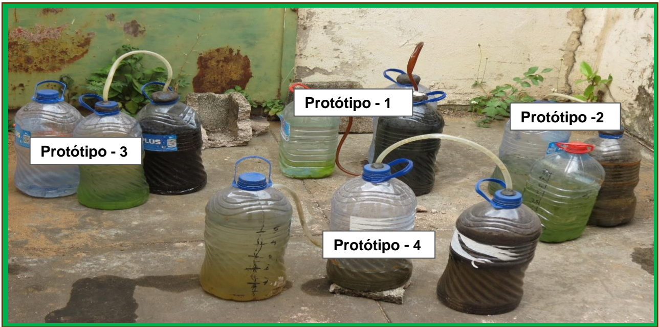
Figura x: Apresentação visual dos Quatro (4) protótipos realizados para ensaiar a produção de biogás.
