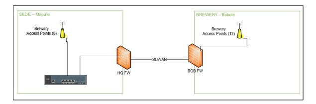
Figura 10: Conexão dos APs antes da mudança. Fonte: Autor
