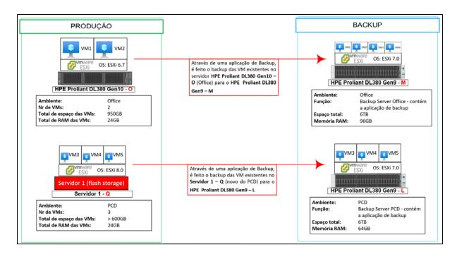
Figura 21: Cenário Pretendido para a existência de Backups com novo servidor do PCD. Fonte: Autor
