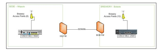
Figura 11: Conexão dos APs depois da mudança. Fonte: Autor
