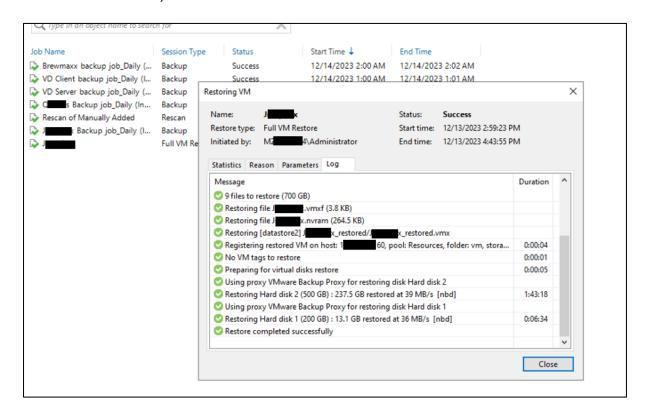
Figura 36: Restauração com sucesso de uma VM a partir do disco externo. Fonte: Autor
