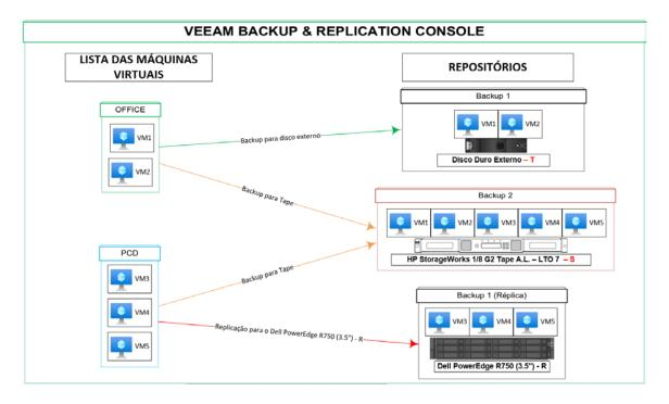
Figura 30: Topologia de backups da infra-estrutura. Fonte: Autor
