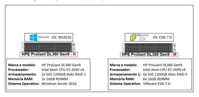
Figura 17: Relação Servidores (N, M) & Máquinas Virtuais existentes. Fonte: Autor
