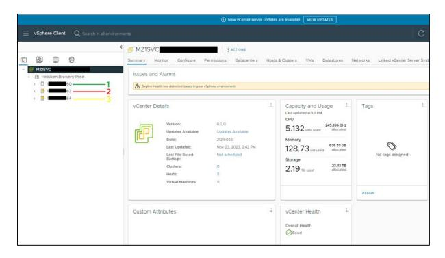
Figura 25: 3 servidores integrados ao virtual datacenter do vCenter. Fonte: Autor
