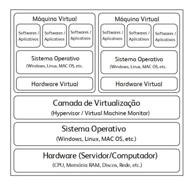
Figura 3: Virtualização com hypervisor do tipo 2. Fonte: (McCrory, Reynolds, & Marshall, 2006)
