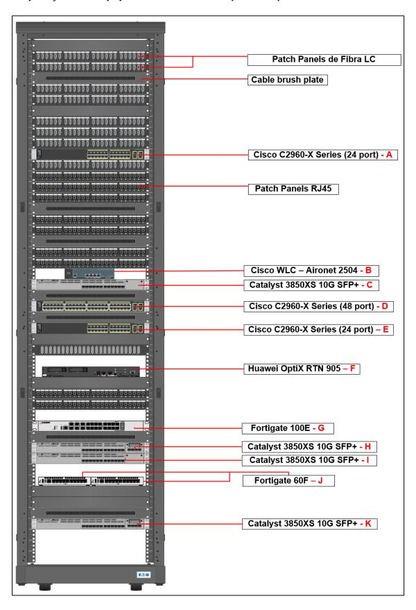
Figura 13: Disposição actual dos dispositivos no Rack 1 (Network) - Fonte: Autor
