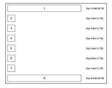
Figura 7: Ilustração de backups incrementais. Fonte: (Nelson, 2011)
