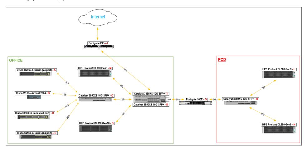
Figura 15: Interligação dos Equipamentos dos Racks. Fonte: Autor
