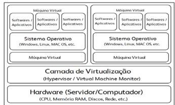
Figura 2: Arquitectura de sistemas virtualizados. Fonte: (McCrory, Reynolds, & Marshall, 2006)
