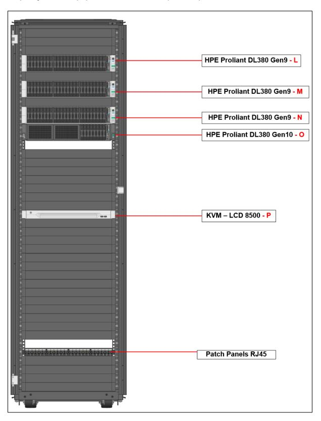
Figura 14: Disposição actual dos dispositivos no Rack 2 (Servers) - Fonte: Autor
