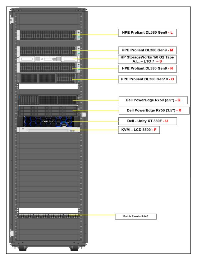
Figura 23: Disposição dos dispositivos no Rack 2 (Servers) após a chegada dos equipamentos - Fonte: Autor
