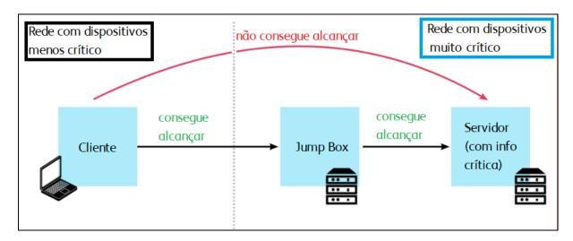
Figura 8: Acesso a um servidor em outra rede usando JumpBox. Fonte: (Servile, 2021)
