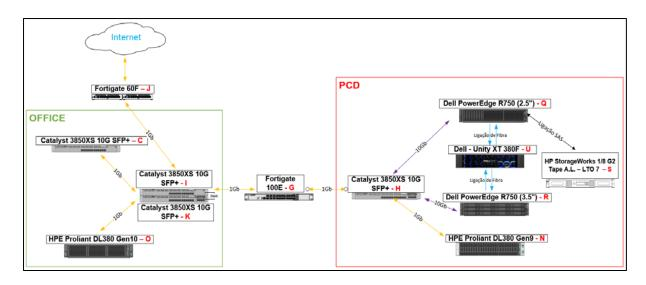
Figura 24: Interligação dos Equipamentos dos Racks após a chegada dos novos equipamentos. Fonte: Autor
