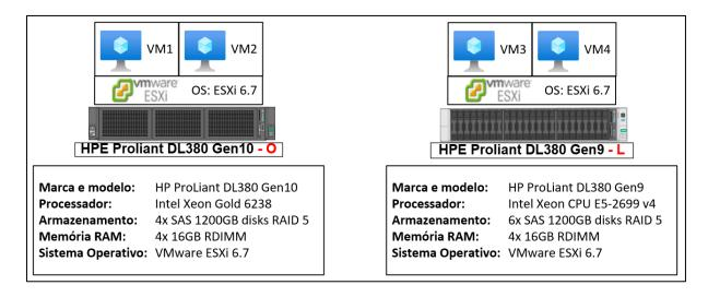
Figura 16: Relação Servidores (O, L) & Máquinas Virtuais existentes. Fonte: Autor
