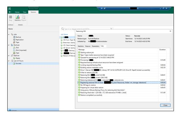
Figura 35: Restauração com sucesso de uma VM a partir da Tape. Fonte: Autor
