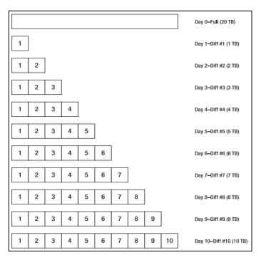
Figura 6: Ilustração de backups diferenciais. Fonte:
