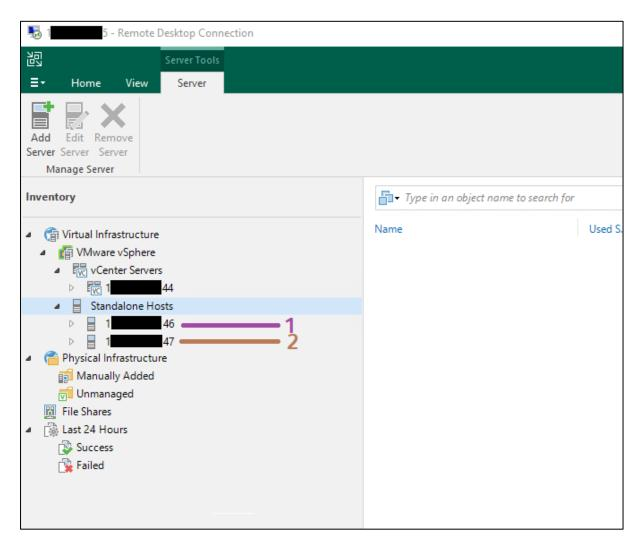
Figura 26: Hosts Standalone do PCD e do Office adicionados no Veeam B&R Console. Fonte: Autor
