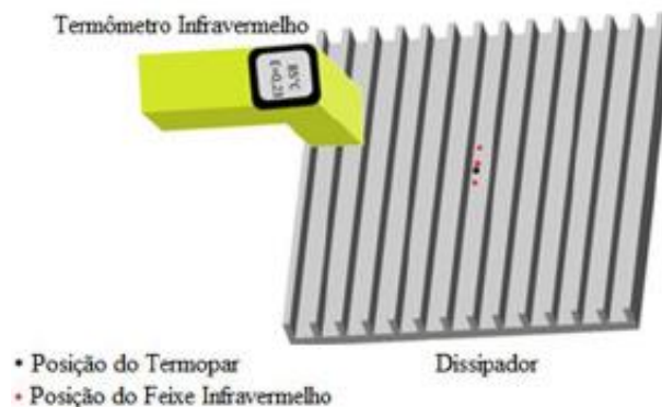
Figura 19: Procedimento realizado para medição da temperatura das faces [Fonte: Adaptado por SILVA, Vilson]
