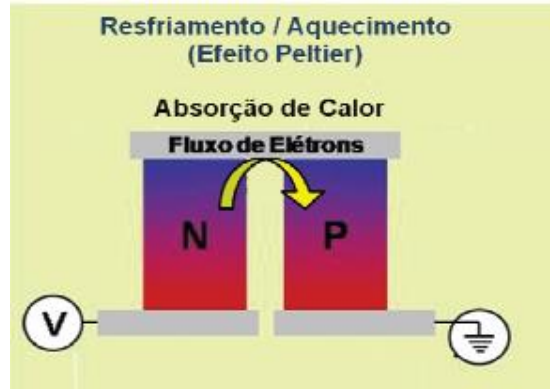
Figura 3: Efeito Peltier em semicondutores [Fonte: Adaptado por SILVERIO, Borges]
