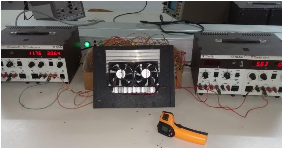
Figura 22: Modelo protótipo final ligado em fontes de laboratório para análise do desempenho [Fonte: Autor]
