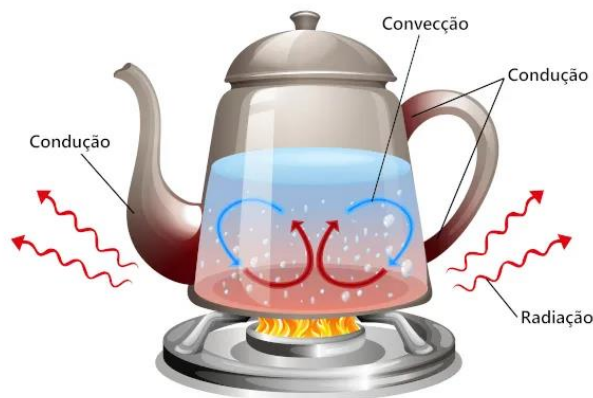
Figura 7: Modos de transferência de calor.
