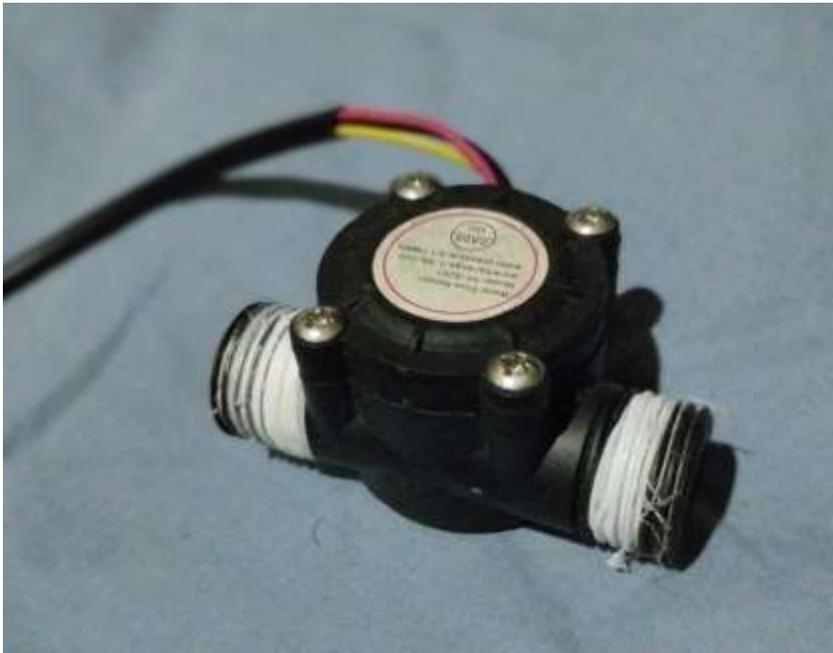
Figure 2.8: Módulo YF-S201. Fonte: (Autor)
