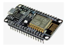
Figura 13: ESP8266 Fonte: Robocraze(2019)
