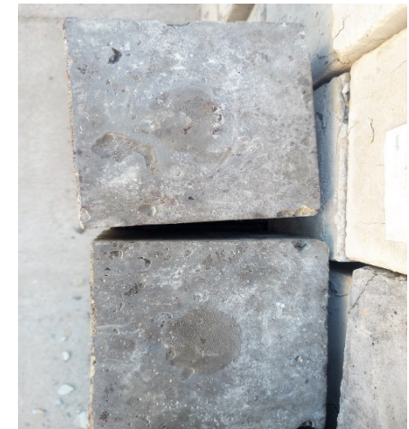
Figura A3 – 10. Execução de ensaio de compressão de cubos de betão na prensa hidráulica e tipo de rotura de provetes.
