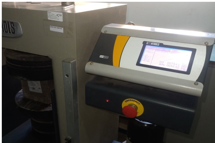
Figura A3 – 10. Execução de ensaio de compressão de cubos de betão na prensa hidráulica e tipo de rotura de provetes.
