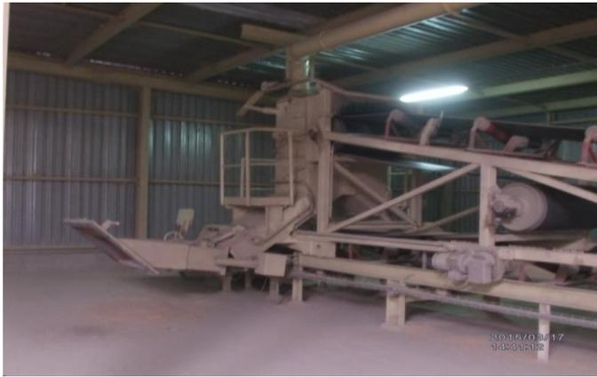
Figura 11: Tripper do transportador de tapete da STEMA
