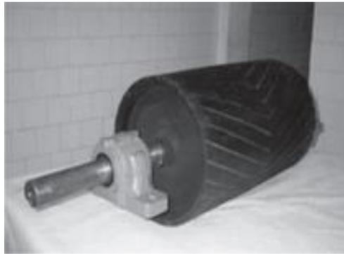
Figura 9: Tambor de accionamento de um transportador de tapete
