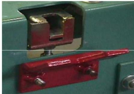
**Figura 13.**Módulo de pesagem. [2]
