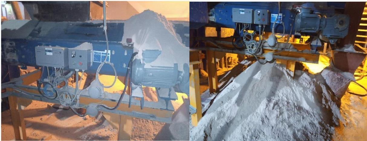
**Figura 31.** Empilhamento de material sobre a estrutura.
