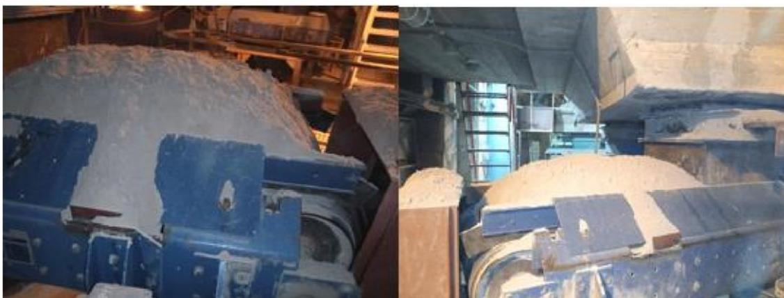
**Figura 32.** Camada de material fora do padrão.
