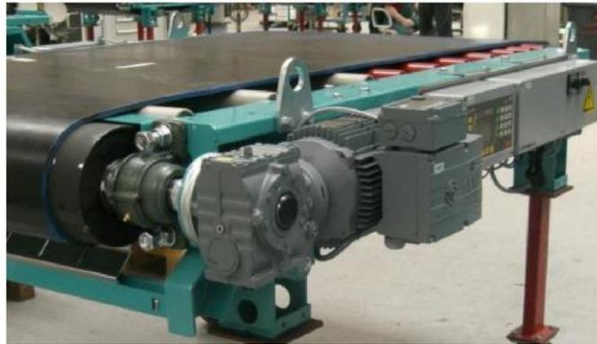
Figura 5. Motor redutor acoplado ao tambor de accionamento da correia da balança. [2]
