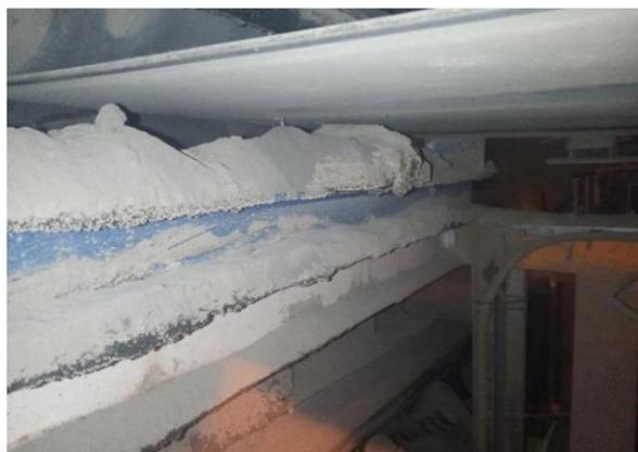
**Figura 30.** Crosta entre a estrutura e a correia.
