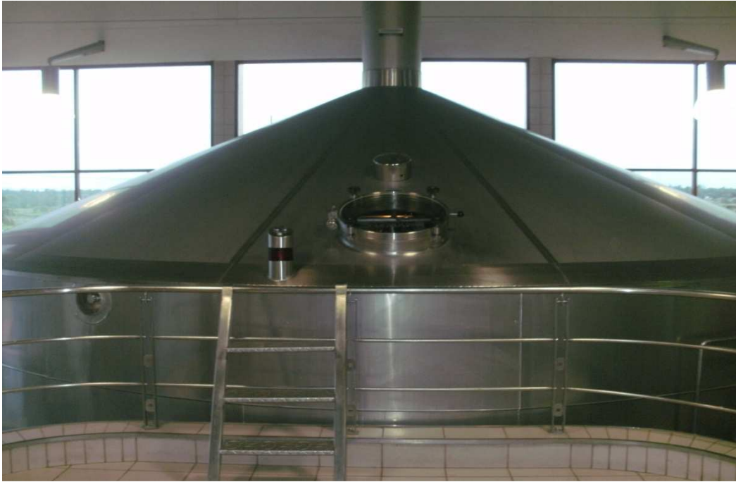
Cuba-filtro – local onde o mosto (parte líquida) é separado do bagaço (parte sólida).
