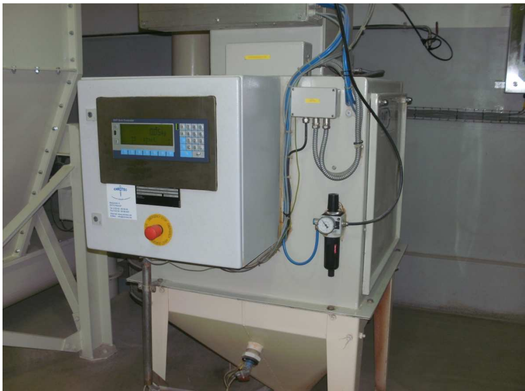
Balança automática – serve para pesar o malte quando sai dos silos para o moinho.
