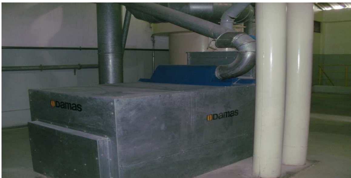
Peneira – tem a função de separar o malte dos lixos que podem trazer do processamento do malte.
