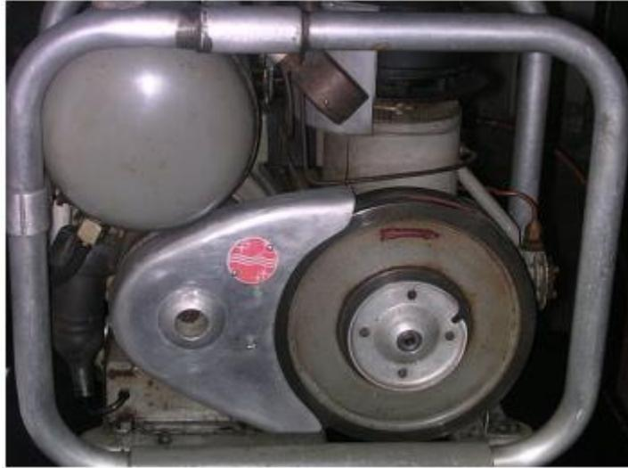
Figura 2: Gerador Stirling da Philips MP1002CA
