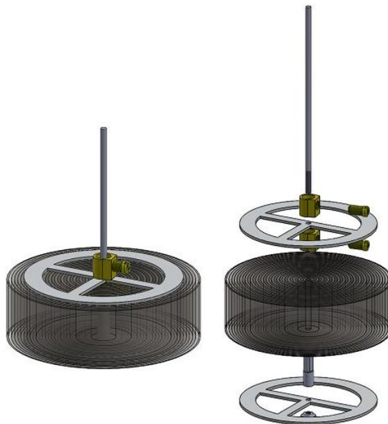
Figura 18: Vista geral e explodida do pistão de deslocamento.
