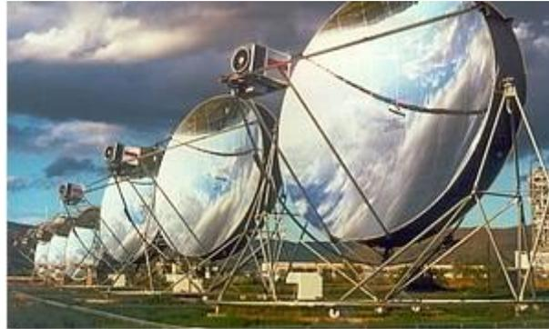
*Figura 10: Concentrador de disco parabólico.*
