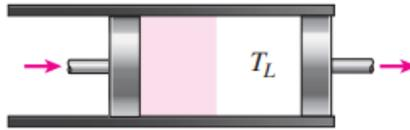
Figura 7: Processo 2-3: Rejeição de calor a volume constante.
