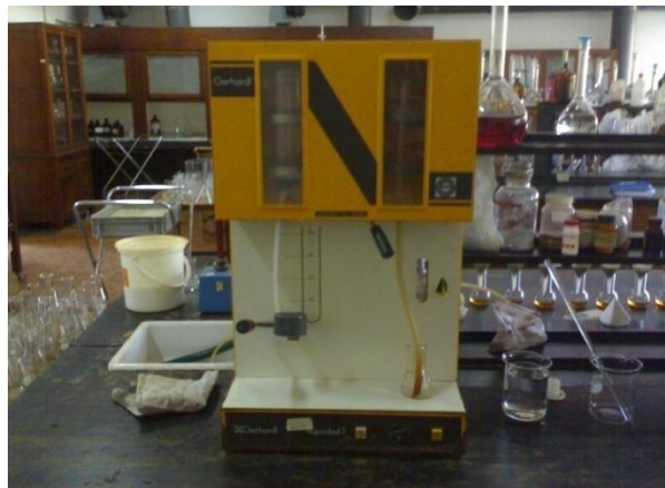
Figura 29: aparelho de destilador de Kjeldahl usado no IIAM.
