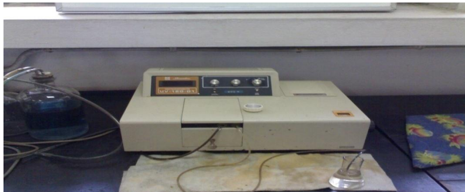
Figura 29: espectrofotómetro UV- Vis usado para as análises disponibilizado pela IIAM.
