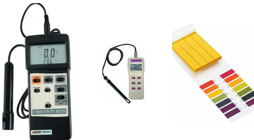
Figura 3-Da esquerda para direita: Conductivímetro, Ph metro e papel indicador de tornasol. Fonte:SPLabor,2016.
