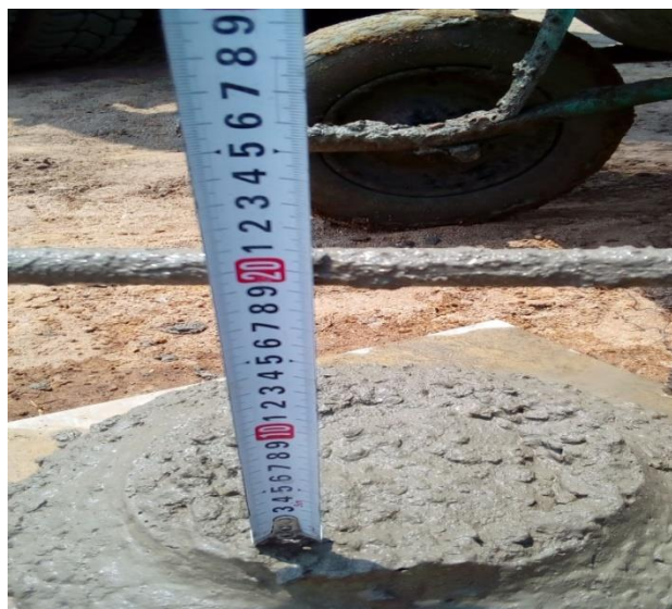
Figura 15: slump test (fonte:Autor)
