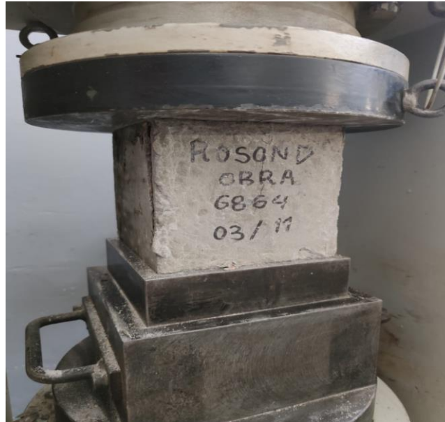
Figura 16: Ensaio dos cubos a compressão (fonte:Autor)
