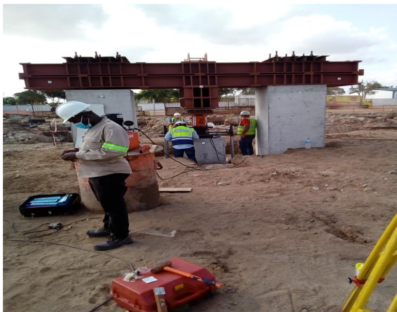
Figura 6: Ensaio de carga estático (fonte: Autor)
