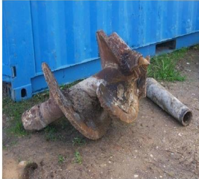
Figura 8: Broca de furação ( \varnothing 600 mm) (fonte:Autor)
