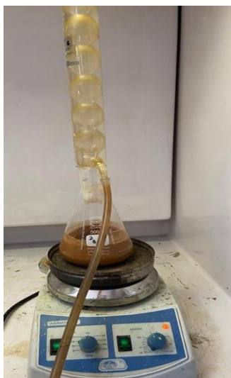
Figura 10 Digestão alcalina da bauxite
