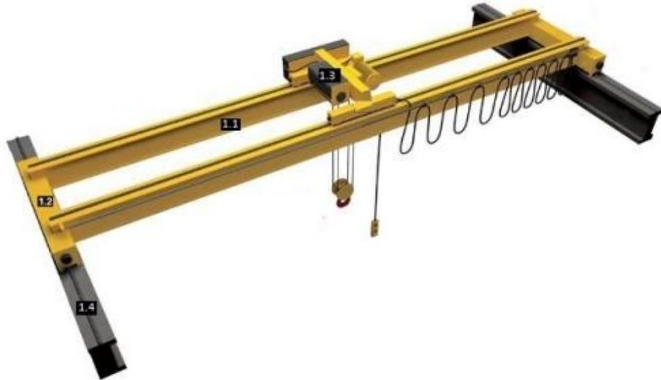
Figura 7: componentes principais de uma ponte rolante
