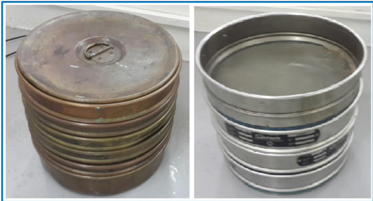
Figura 3: Crivos em escala milimétrica utilizados para a crivagem no laboratório de Sedimentologia.
