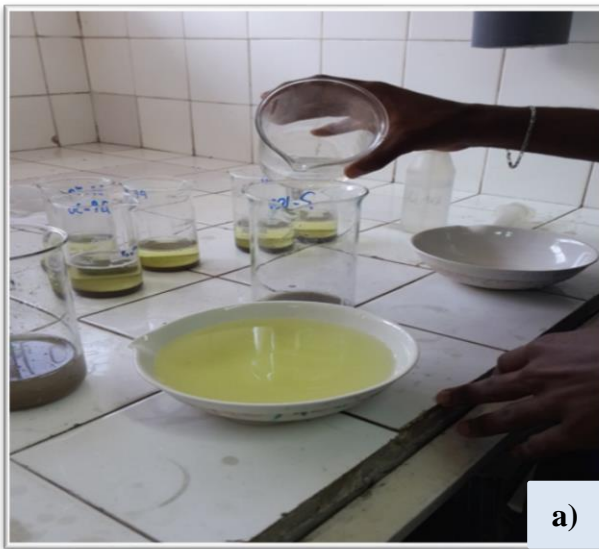
Figura 7: Remoção de Carbonatos e MO nos sedimentos (a) e crivos usados (b).
