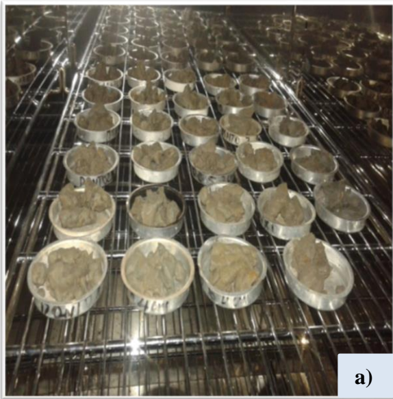
Figura 6: (a) Amostras no interior da estufa e (b) uma amostra sendo pesada na balança analítica.
