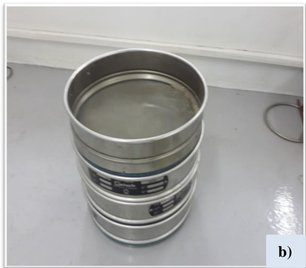
Figura 7: Remoção de Carbonatos e MO nos sedimentos (a) e crivos usados (b).
