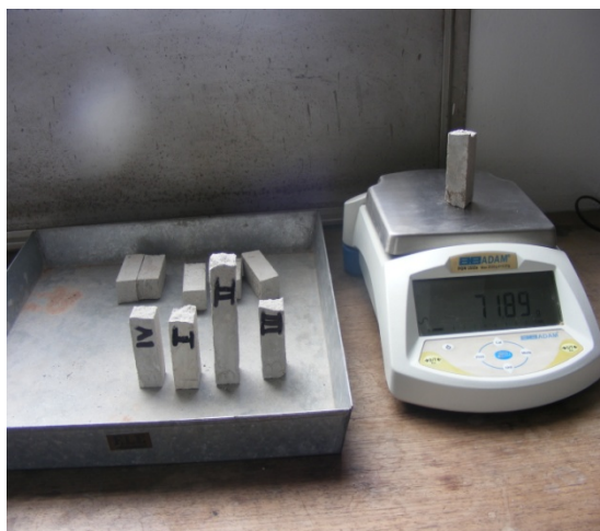
Figura 12: Pesagem do provete seco ( m_2 )
