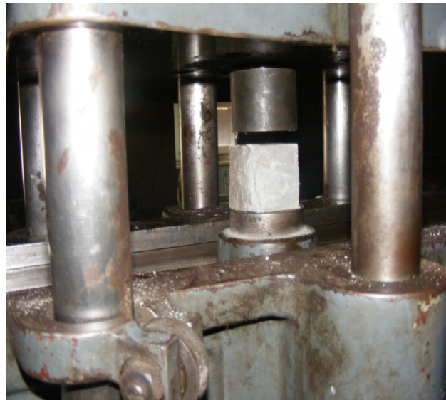
Figura 11: Rompimento do provete na resistência à compressão
