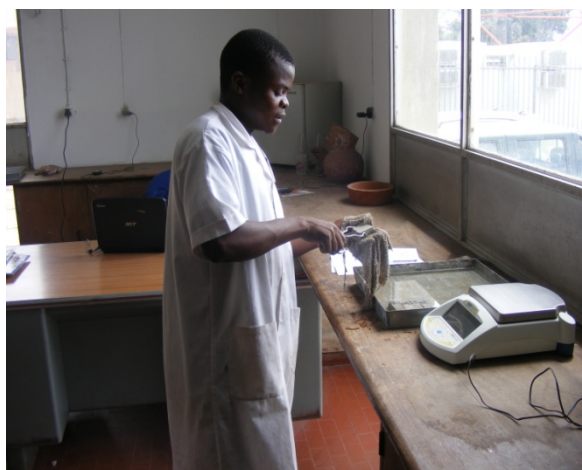
Figura 13: Pesagem do provete no ar (saturado e enxuto na superfície) ( m_3 )
