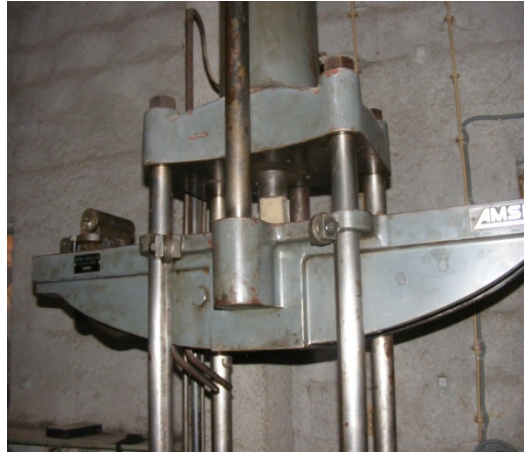
Figura 10: Ensaio de resistência à compressão
