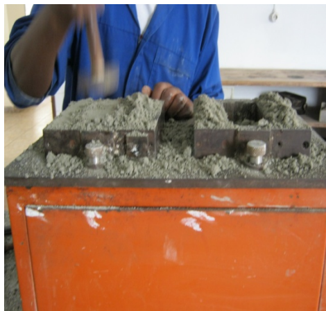
Figura 5: Moldagem dos provetes prismáticos
