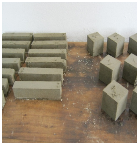
Figura 6: Secagem dos provetes
