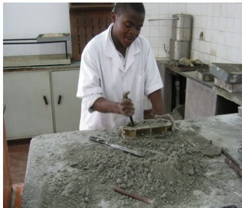
Figura 4: Moldagem dos provetes cúbicos
