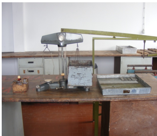
Figura 14: Pesagem do provete imerso na água ( m_4 )
