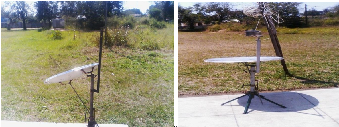
Figura 5: Fogão solar do tipo parabólico em estudo. Fonte: Autor
