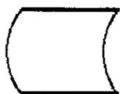
Armazenamento on-line - Símbolo generalizado para qualquer tipo de armazenamento on-line, incluindo disco, tambor magnético, dispositivo de armazenamento de massa, disquete, etc.
