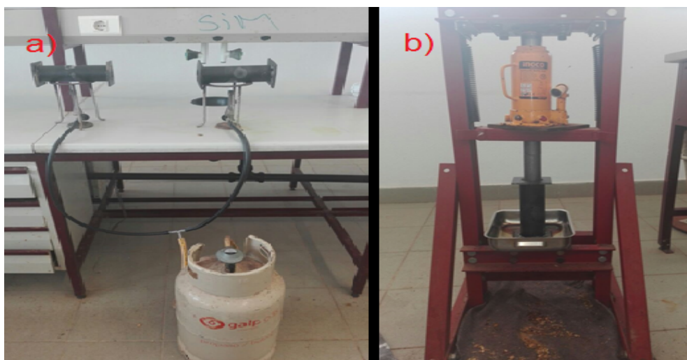
Figura 3.3 – (a) Pré-aquecimento das sementes de abóbora; (b) Extração do óleo de sementes de abóbora.
