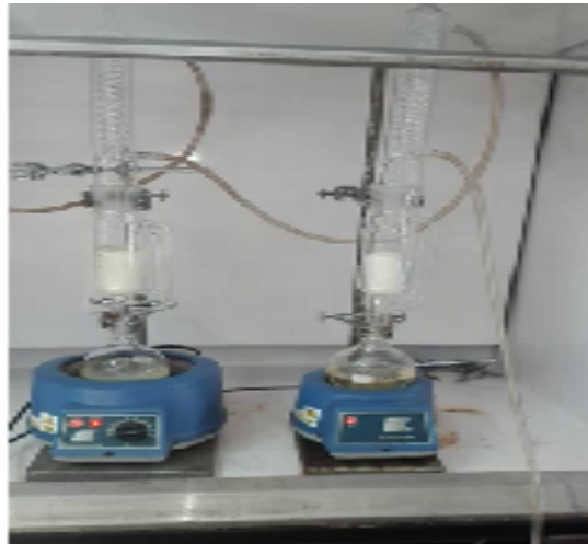
Figura 3.2 – Determinação de gordura no extractor soxhlet.
