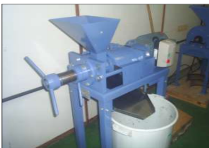
Figura 2.2 – Prensa mecânica (Teixeira, 2013).
